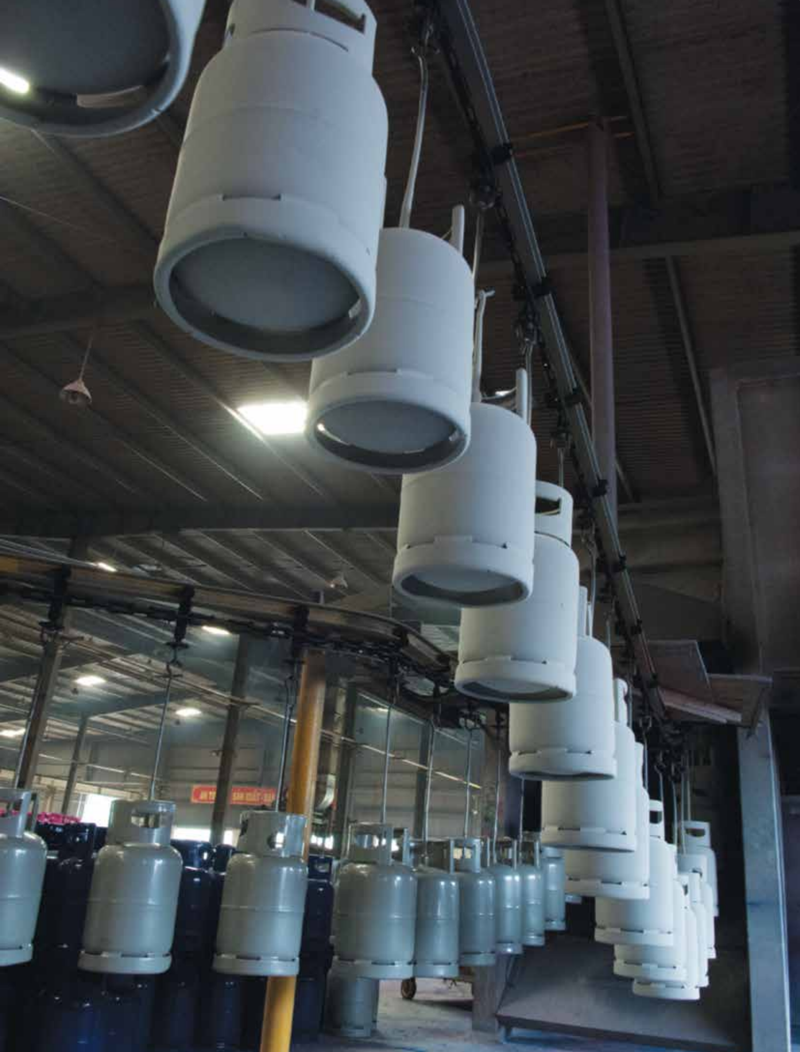
Dây chuyền sản xuất bình chứa LPG tại Nhà máy Bình khí Dầu khí
